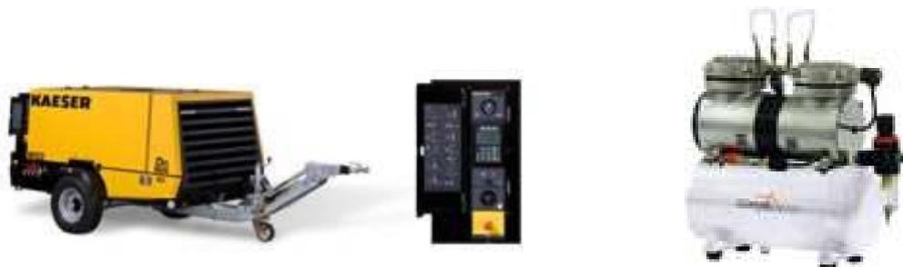
Il compressore mobile, portatile o carrellato, in genere con motore diesel ma anche elettrico, viene impiegato in numerose operazioni di varia natura per la manutenzione degli impianti e degli edifici, ma anche per piccole demolizioni, lavorazioni edili e durante l'apprestamento di fori ed ancoraggi.
