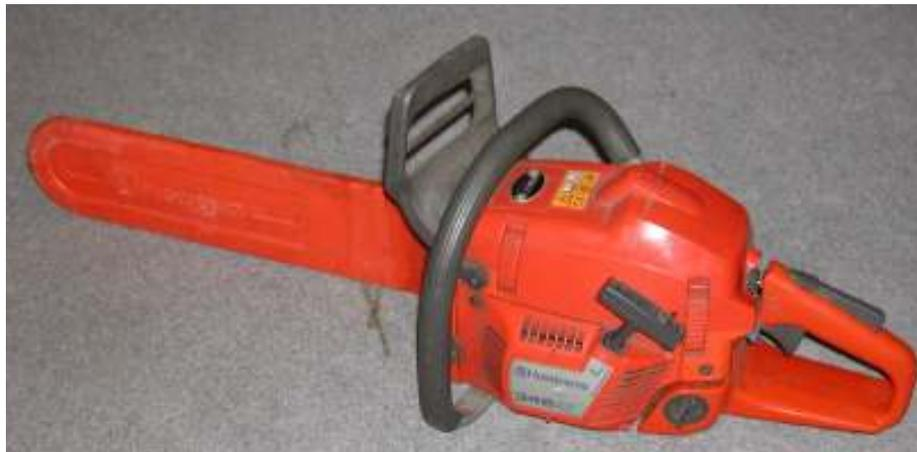
La motosega, in genere con motore a scoppio, e più raramente elettrica, viene impiegata in alcune operazioni inerenti in particolare la manutenzione delle piste, il mantenimento della percorribilità e dei franchi lungo le linee degli impianti a fune e durante l'apprestamento di staccionate ed altri manufatti in legno.
