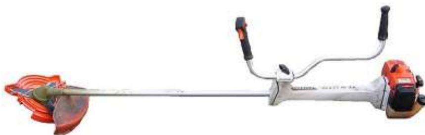
Il decespugliatore, in genere con motore a scoppio e molto più raramente elettrico, viene impiegato in alcune operazioni inerenti in particolare la manutenzione delle piste, il mantenimento della percorribilità dei sentieri e delle zone pedonali erbate.
